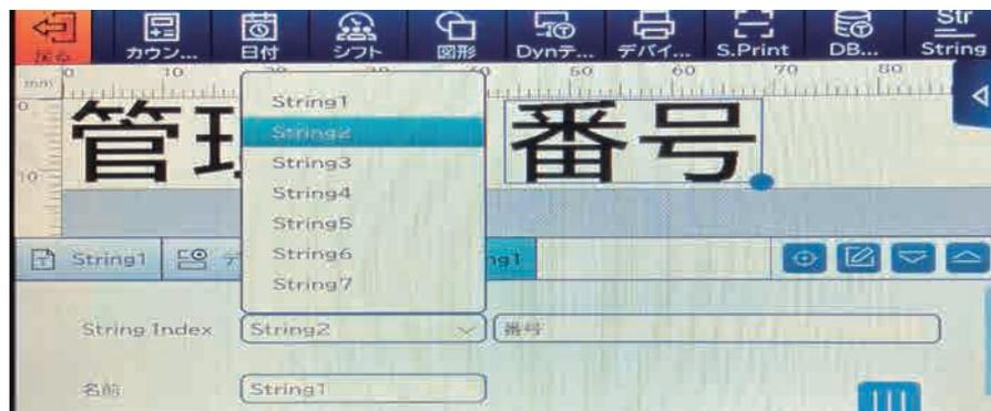
同様に String Index のドロップダウンで、String2 を選択し、テキストボックスにテキストを入力すると、入力されたテキストが String2 に紐付けされます。次回 String オブジェクトを作成 / 編集時に、String Index より、紐付けされたテキストを選択し、テキスト入力せずに、テキストを表示することができます。
