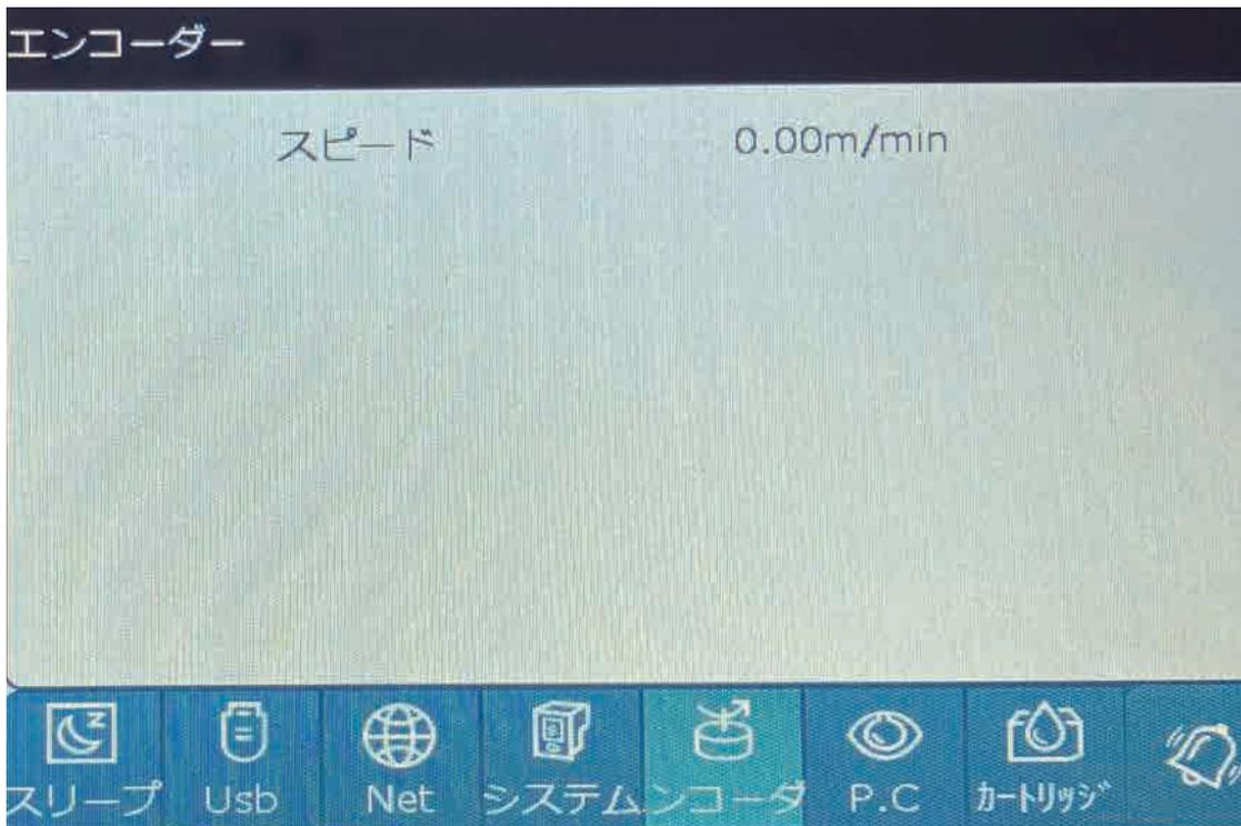
エンコーダー：ラインスピード、印字スピードを検知するプリンタに内臓されたセンサー。
