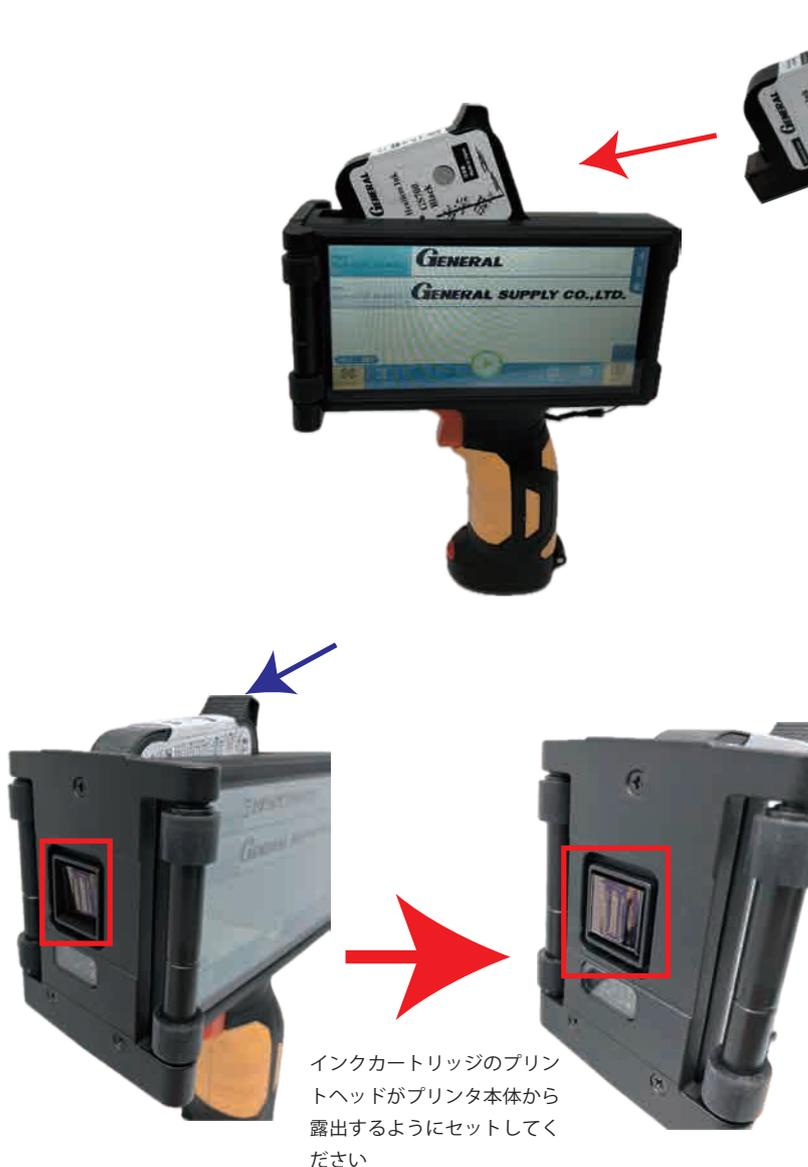
インクカートリッジを取り外す場合は、取外しレバーをスライドさせてから、インクカートリッジを引き抜いてください。
