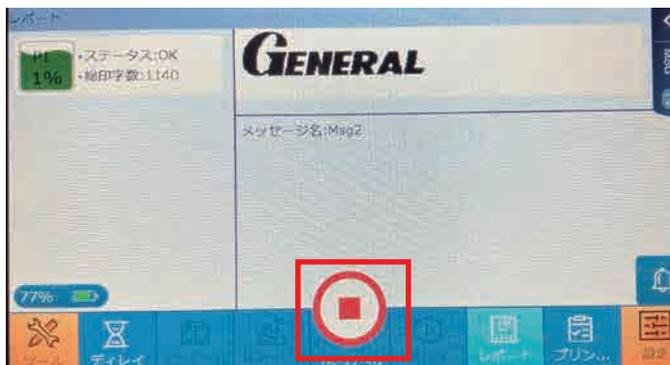
※インクカートリッジをプリンタから取外す時は、必ず、印字を停止してから、インクカートリッジを取外してください。
