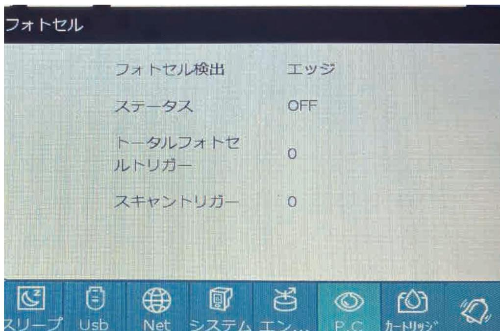
フォトセル：印字対象物を検知するプリンタに内臓されたセンサー。
