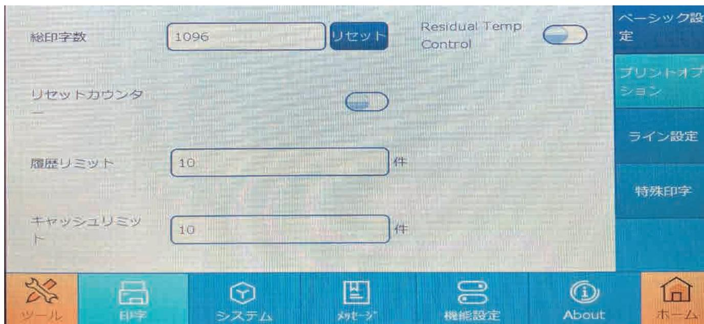
履歴リミット：デバイスが保存する印字履歴のレコードの数
