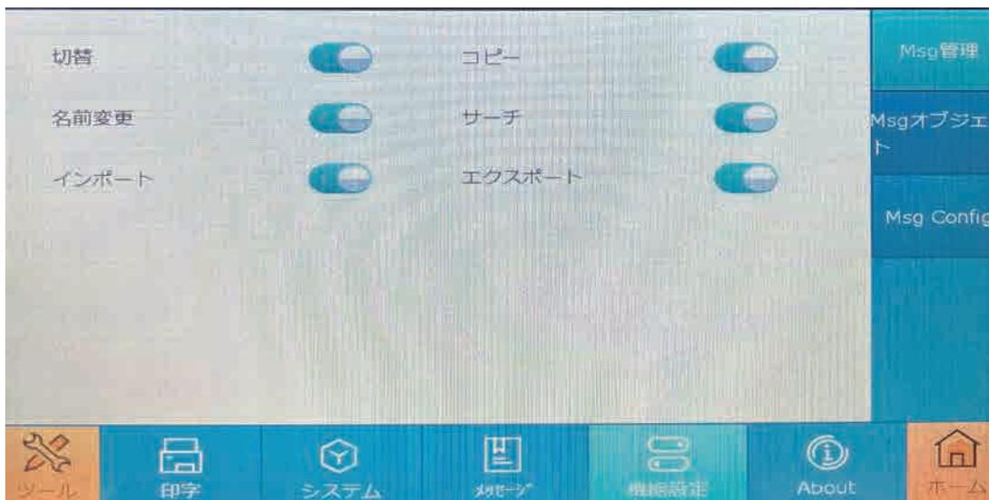
メッセージ管理:すべての機能項目はデフォルトで有効になっています。一部の機能がオフに設定されている場合、機能項目は表示されません。ツールバーを右側に表示するかどうかを設定できます。メッセージ一覧画面には、「切替」、「コピー」、「名前変更」、「サーチ」、「インポート」、「エクスポート」機能が表示されます
