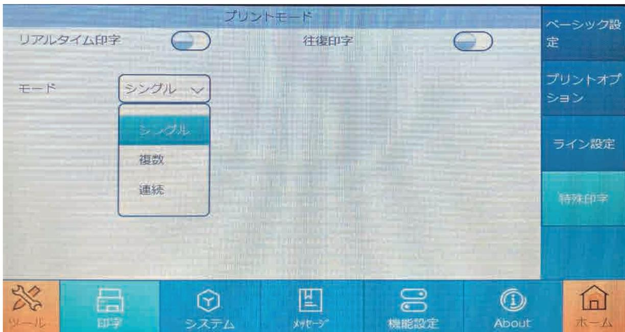
リアルタイム印字：フォトセルの感知時間に基づいてリアルタイム印字が実行されます。
