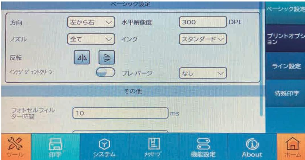
方向：印字方向を設定します（デフォルトでは左から右）。
