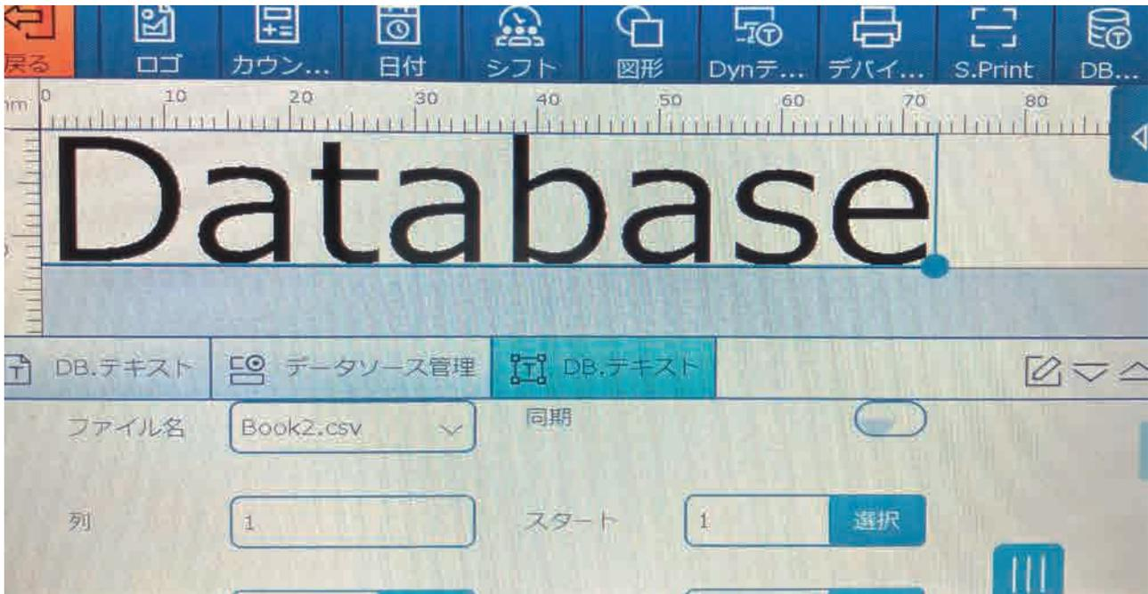
CSV ファイルを USB デバイスへコピー、USB デバイスをプリンタの USB ポートに挿入してください。
