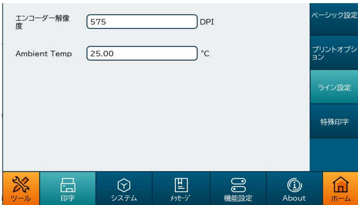
エンコーダー：ラインスピード、印字スピードを検知するプリンタに内臓されたセンサー。
