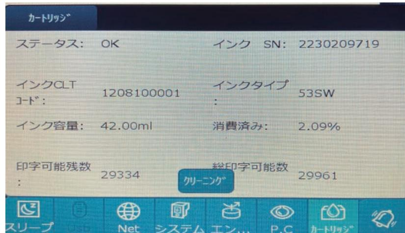
「カートリッジ」アイコン
