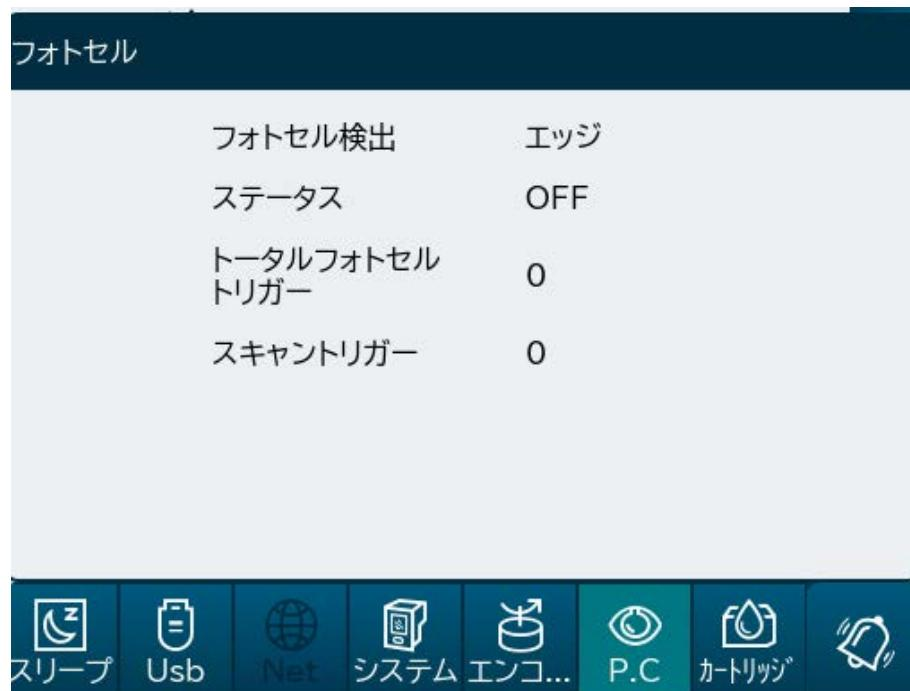
フォトセル：印字対象物を検知するプリンタに内臓されたセンサー。
